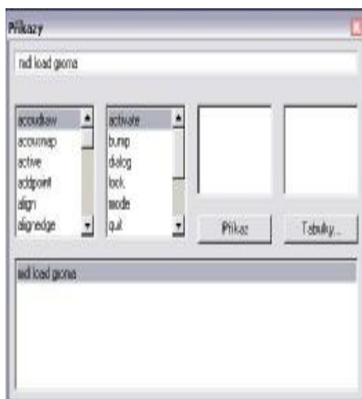
Obr. 51 Spuštění Gromy v Microstationu
