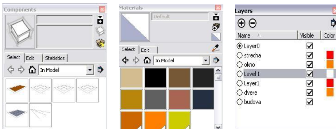
Obr. 98 Základní vlastnosti naimportované budovy z Microstationu (vlevo obsažené komponenty, uprostřed materiály, vpravo vrstvy)
