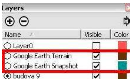
Obr. 85 Zapnutí vrstev terénu před exportem do 3DWarehouse
