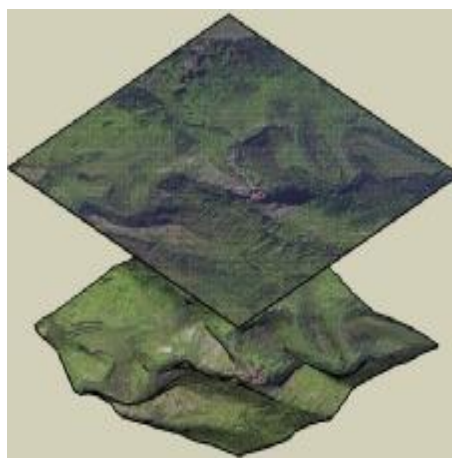
Obr. 31 b) Model po přiřazení textury (ortofotomapa)
